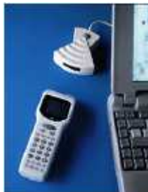
Dévidage à distance par borne infra-rouge
